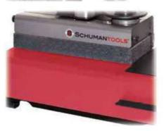
Granito naturale impiegato sia per la colonna sia per la base. La stabilità termica di questo materiale, permette di collocare la macchina in officina. La meccanica è realizzata con impiego di acciao inox.
