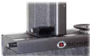
Registrazione micrometrica degli assi X e Z con due pomelli. Indispensabili per collimare la misura su target fisso.
