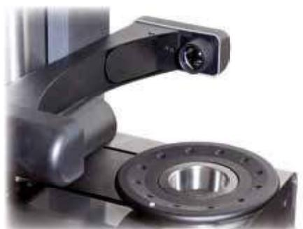
Granito naturale impiegato sia per la colonna sia per la base. La stabilità termica di questo materiale, permette di collocare la macchina in officina. La meccanica è realizzata con impiego di acciaio inox.
