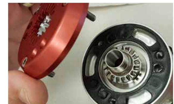
Posizionare il coperchio anteriore sull'unità assemblata e serrare le viti
