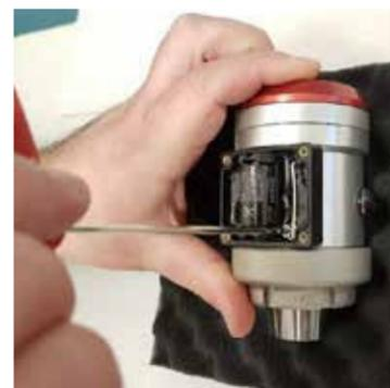
Stringere le viti di fissaggio del trasmettitore
