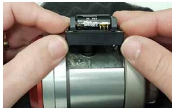
Rimuovere il trasmettitore di velocità
