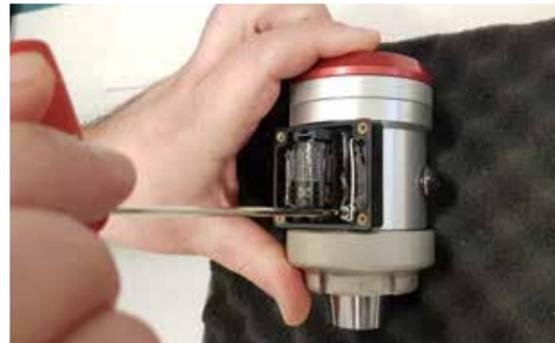
Rimuovere le viti di fissaggio del trasmettitore
