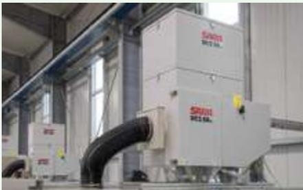
UC2-SDIII con elemento per filtro per sospensioni, montaggio sulla macchina
