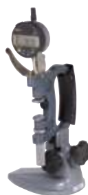
Esempio di applicazione con comparatore digitale e supporto
