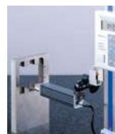
Uso con misuratore di altezza 5305020300 tramite adattatore 5705310016
