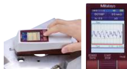
Rappresentazione di profilo in tempo reale durante la misurazione
