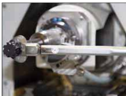
Posizionare la chiave dinamometrica il più possibile orizzontalmente sulla testa sostituibile e non inclinare rispetto alla superficie per la chiave.
