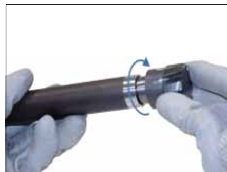
Inserire la testa sostituibile nel relativo supporto ruotandola manualmente in senso orario. Successivamente, serrare il supporto della testa sostituibile insieme all'utensile nel supporto della macchina.
