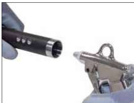
Pulire il supporto della testa sostituibile su cono, filetto e superficie piana con aria compressa e un panno.
