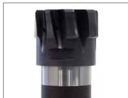
Risultato: lo spazio tra testa sostituibile e supporto della testa sostituibile è chiuso ed è presente un collegamento ad accoppiamento di forza e di forma. La testa sostituibile ora è pronta per l'utilizzo.
