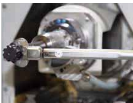
Serrare la testa sostituibile con l'ausilio della chiave dinamometrica e della chiave a tubo adatta alla coppia di serraggio indicata (vedere tabella "Coppie di serraggio delle teste sostituibili").
