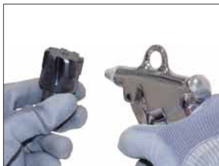
Pulire la testa sostituibile su cono, filetto e superficie piana con aria compressa e un panno.
