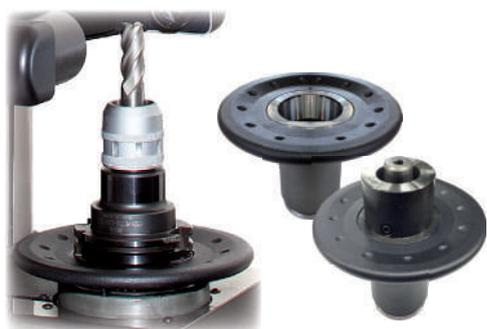
Mandrino rotante intercambiabile con freno meccanico della rotazione. Due gabbie di sfere precaricate permettono precisioni di concentricità entro i 4  $\mu\text{m}$ .
