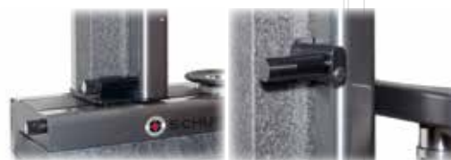
Registrazione micrometrica degli assi X e Z con due pomelli
